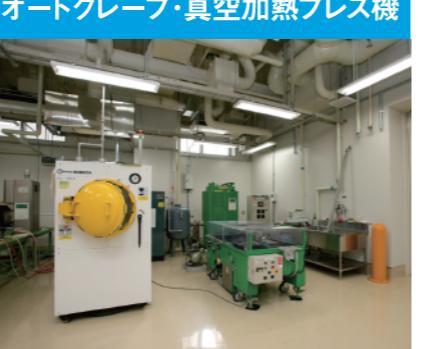
高強度軽量材料としてのFRP試作機。曲面、立体構造の試作も可能。
