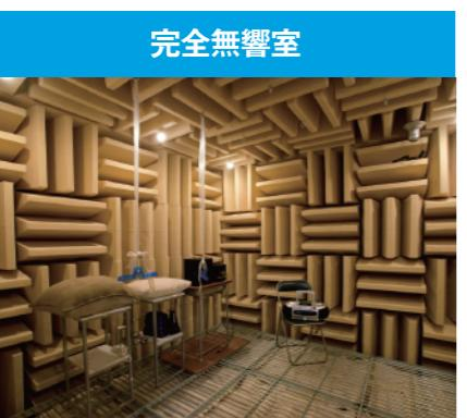
残響が非常に少ない特別な実験室。動作音測定、音響機器開発や残響室と連結して遮音効果の測定も可能。
