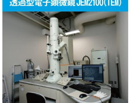
200kV汎用型次世代電子顕微鏡。バイオからマテリアルまであらゆる分野の研究開発を支援。
