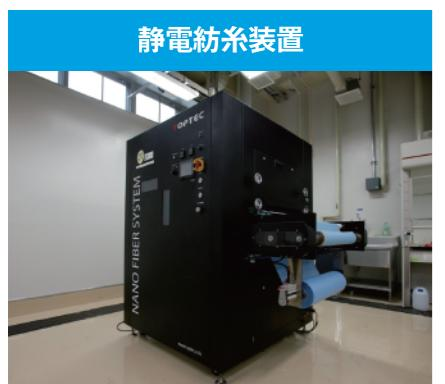
ナノファイバー試作装置。600mm幅の連続ウェブシート試作が可能。
