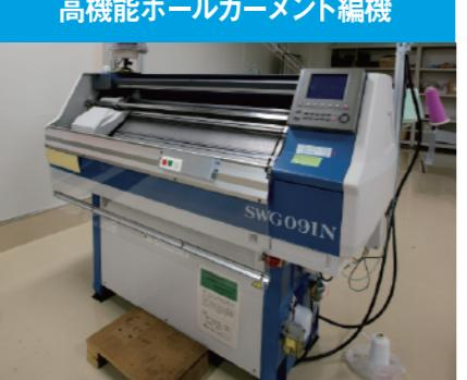
無縫製のホールガーメント編み機。CADによる編み設計から試作まで可能。
